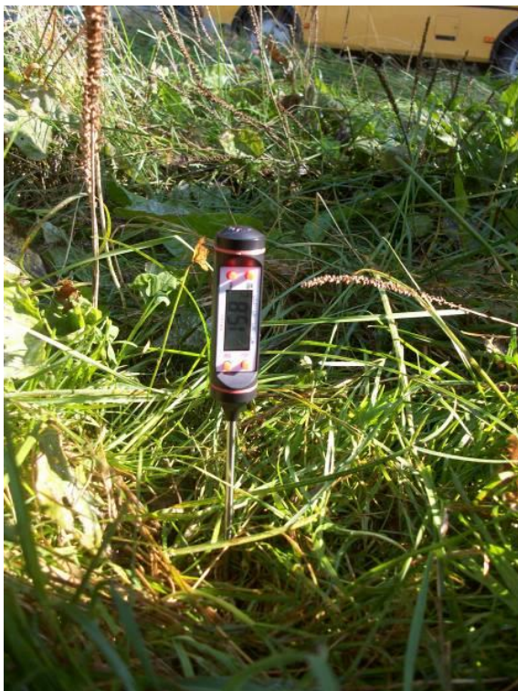
Рис.11 Термометр-щуп для измерения температуры почвы.
