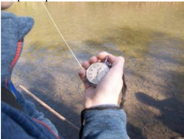
Рис.28 Измерение скорости прохождения поплавков секундомером.
