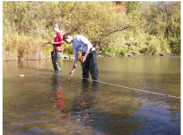
Рис.27 Измерение скорости поверхностных течений поплавками.
